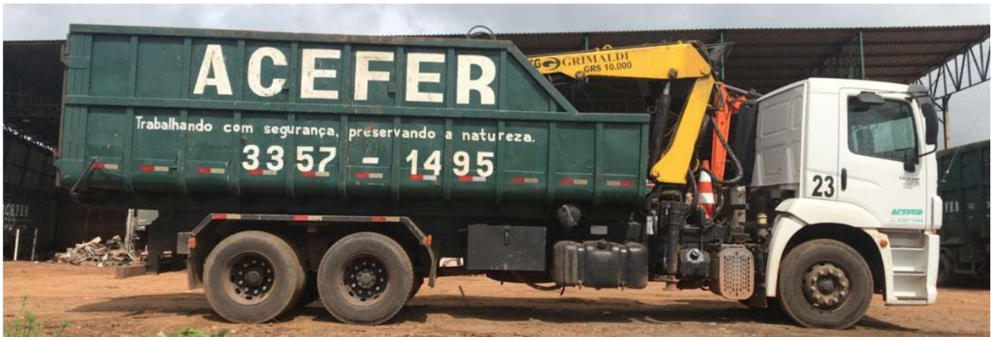
FOTO – 02 VISTA LATERAL DIREITA DA CAÇAMBA BASCULANTE SUCATEIRO INSTALADA NO CAMINHÃO JUNTAMENTE COM O GUINDASTE HIDRÁULICO GRS 10.000
