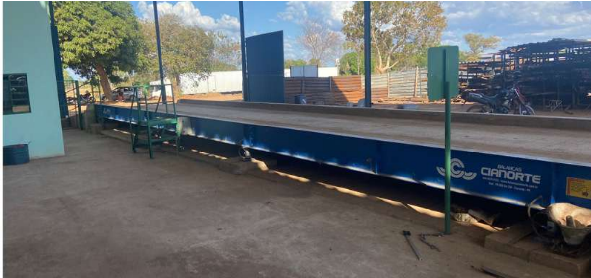
FOTO – 01 VISTA LATERAL DA BALANÇA RODVIÁRIA MARCA CIANORTE
