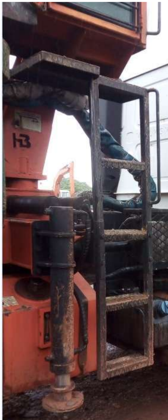
FOTO – 04 ESCADA DE ACESSO AO GUINDASTE SUCATEIRO HIDRÁULICO INSTALADA NO CAMINHÃO
