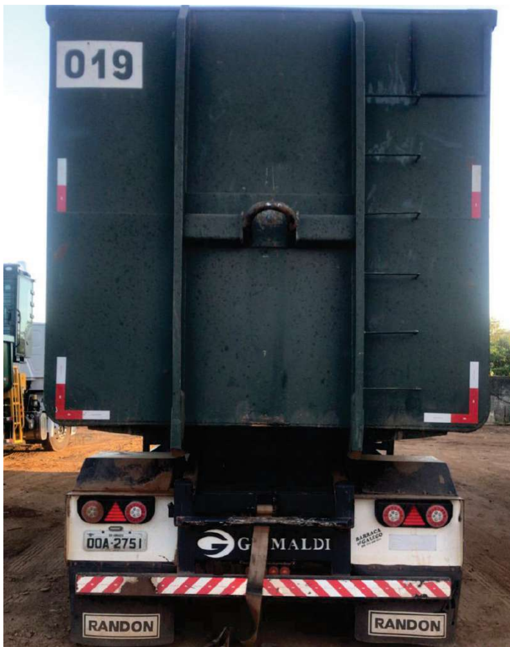
FOTO – 01 VISTA TRASEIRA DO REBOQUE JULIETA COM A CARROCERIA ROLL-ON ROLL-OFF INSTALADO E O CONTÊINER PARA TRANSPORTE DE SUCATA
