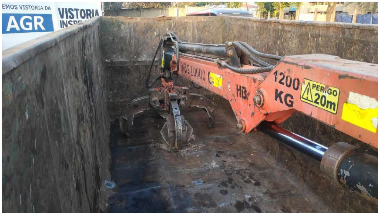
FOTO – 07 ESTRUTURA DO GUINDASTE SUCATEIRO HIDRÁULICO COM A GARRA INSTALADA NO CAMINHÃO
