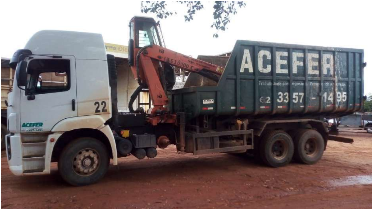
FOTO – 03 VISTA LATERAL ESQUERDA DA CAÇAMBA E O GUINDASTE SUCATEIRO HIDRÁULICO INSTALADOS NO CAMINHÃO
