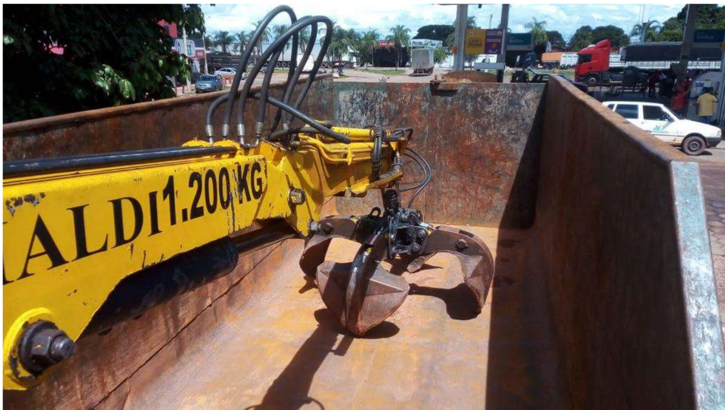
FOTO – 04 ESTRUTURA/LANÇA DO GUINDASTE COM A GARRA
