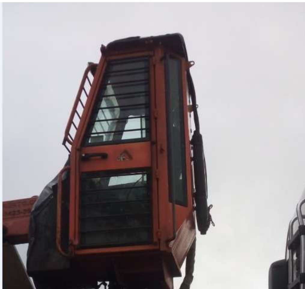
FOTO – 05 CABINE FICHADA DO GUINDASTE SUCATEIRO HIDRÁULICO INSTALADA NO CAMINHÃO
