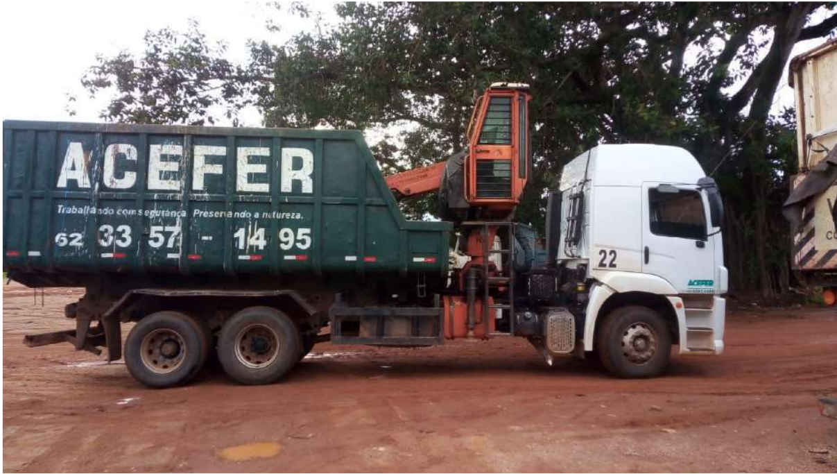
FOTO – 02 VISTA LATERAL DIREITA DA CAÇAMBA E O GUINDASTE SUCATEIRO HIDRÁULICO INSTALADOS NO CAMINHÃO
