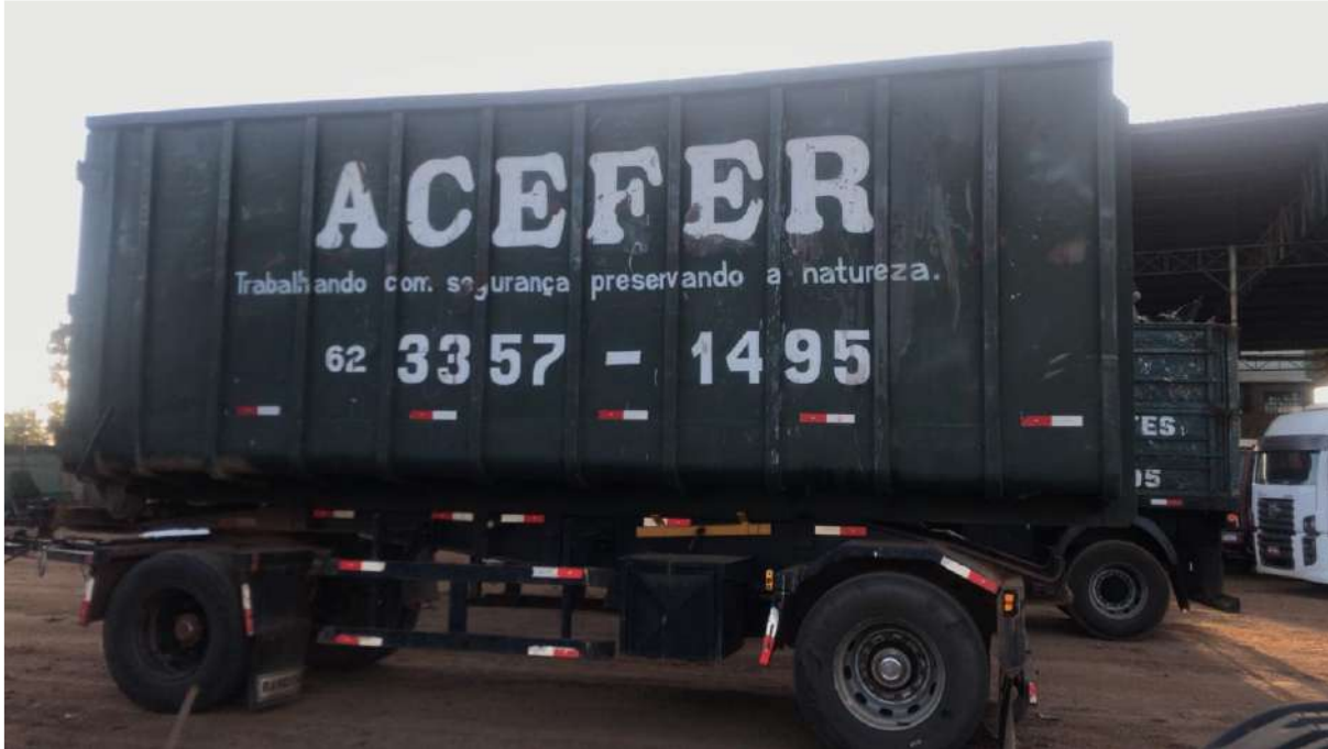
FOTO – 03 VISTA LATERAL ESQUERDA DO REBOQUE JULIETA COM A CARROCERIA ROLL-ON ROLL-OFF INSTALADO E O CONTÊINER PARA TRANSPORTE DE SUCATA
