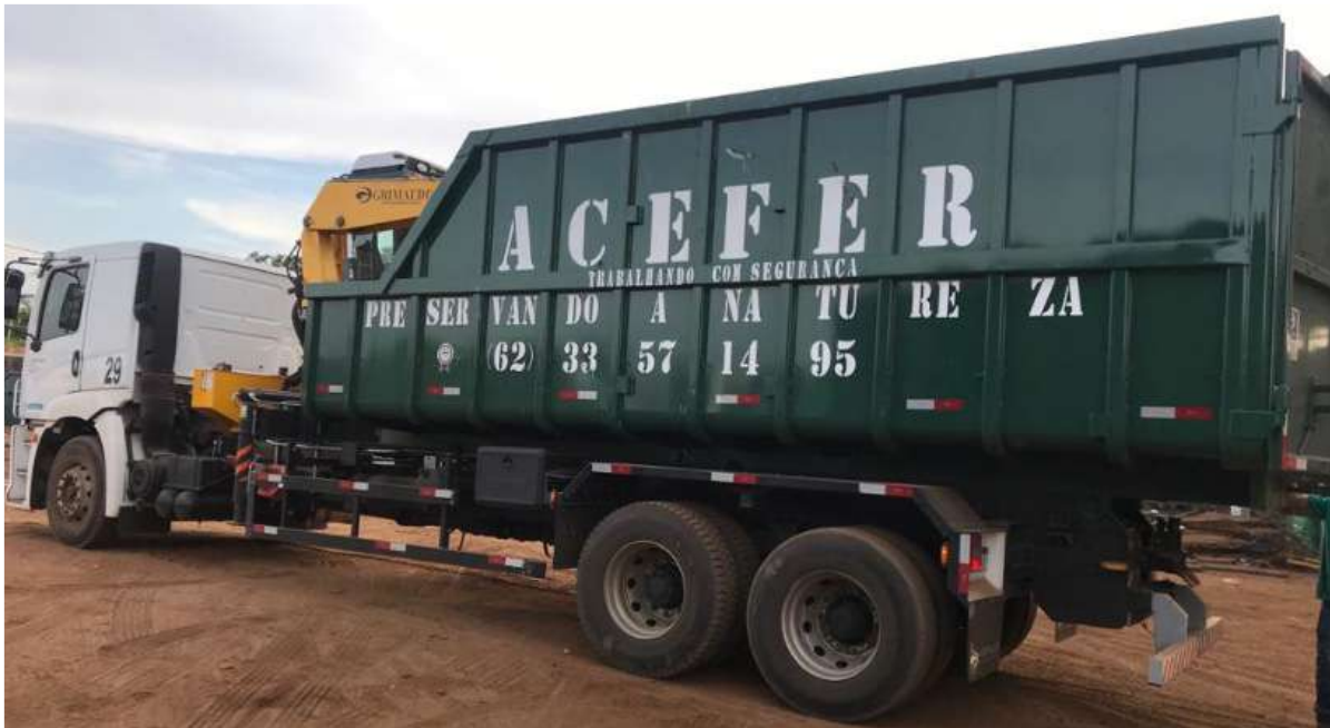
FOTO – 03 VISTA LATERAL ESQUERDA DA CAÇAMBA E O GUINDASTE SUCATEIRO HIDRÁULICO INSTALADOS NO CAMINHÃO
