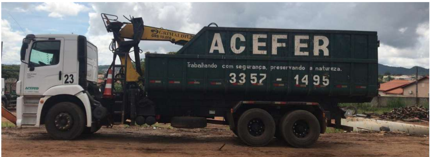
FOTO – 03 VISTA LATERAL DA CAÇAMBA BASCULANTE SUCATEIRO INSTALADA NO CAMINHÃO JUNTAMENTE COM O GUINDASTE HIDRÁULICO GRS 10.000
