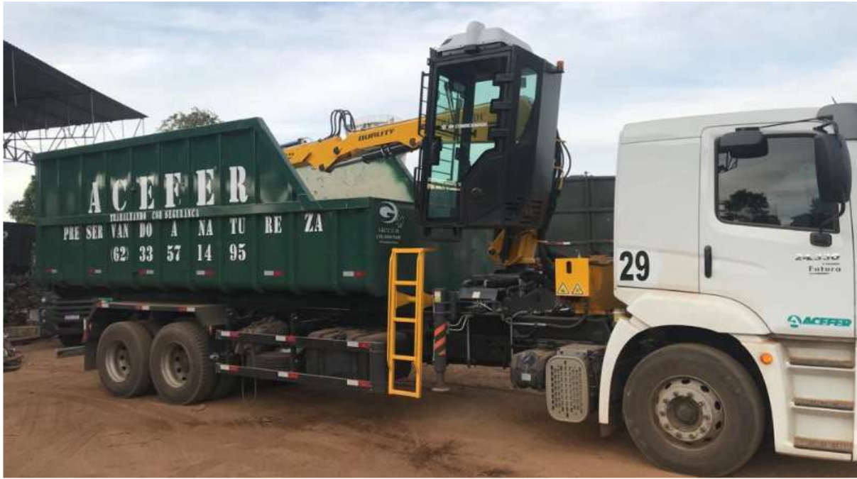
FOTO – 02 VISTA LATERAL DIREITA DA CAÇAMBA E O GUINDASTE SUCATEIRO HIDRÁULICO INSTALADOS NO CAMINHÃO
