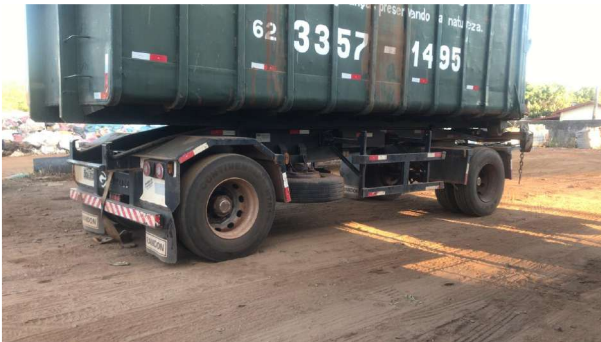
FOTO – 04 VISTA LATERAL DIREITA DO REBOQUE JULIETA COM A CARROCERIA ROLL-ON ROLL-OFF INSTALADO E O CONTÊINER PARA TRANSPORTE DE SUCATA
